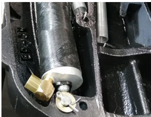
Vérin composite pour modèles à commande pneumatique en cabine
